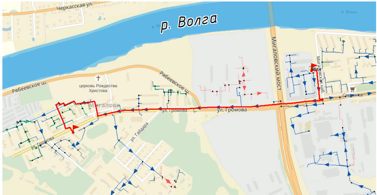
Рисунок 1.20 – Путь движения теплоносителя от ВК1 до потребителя г. Тверь, ул. Громова 54
