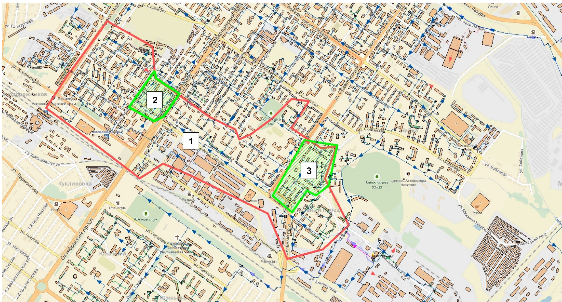
Рисунок 1.52 - Зоны теплоснабжения с учетом перераспределения нагрузки между ТЭЦ-4 и котельной «Южная»
