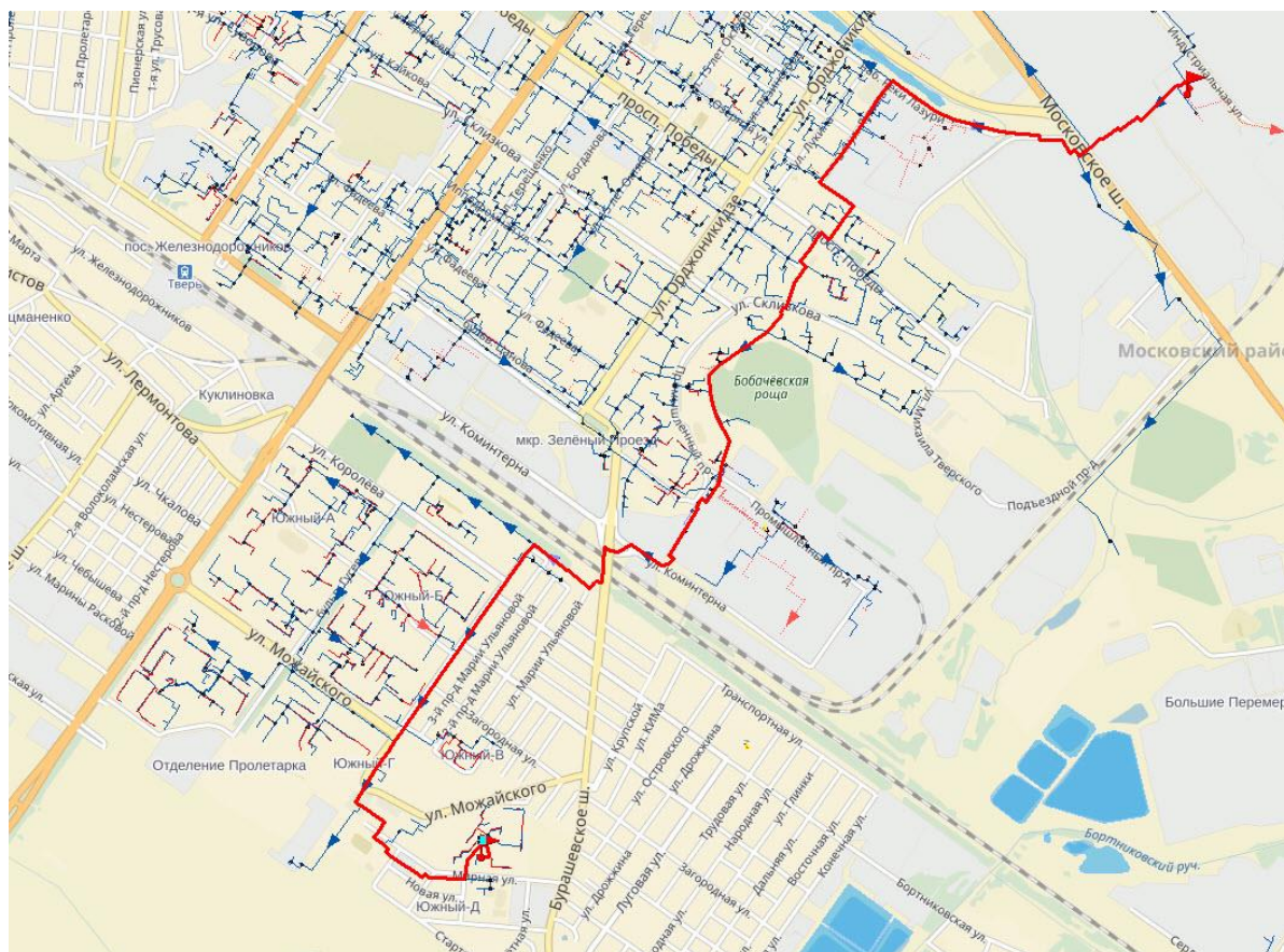
Рисунок 1.41 – Путь движения теплоносителя от ТЭЦ-4 до потребителя по адресу г. Тверь, ул. Можайского 70
