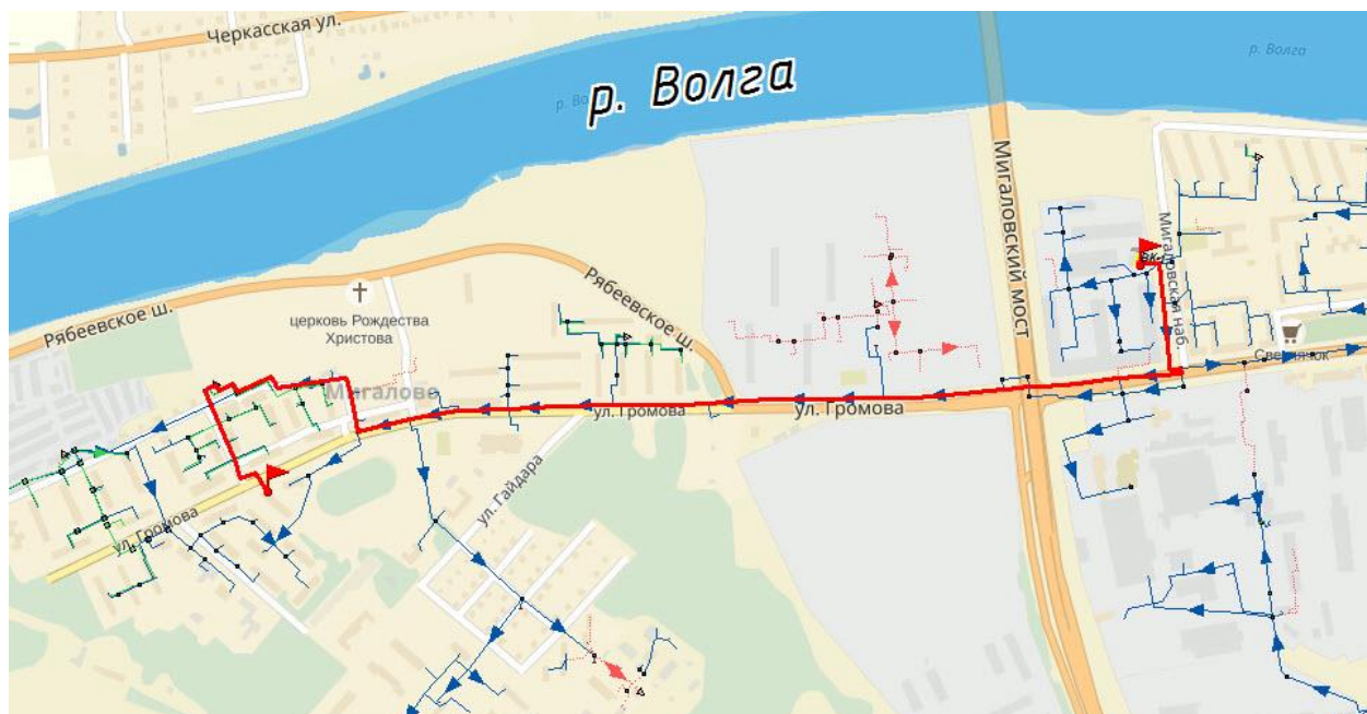
Рисунок 1.21 – Путь движения теплоносителя от ВК1 до потребителя г. Тверь, ул. Громова 54
