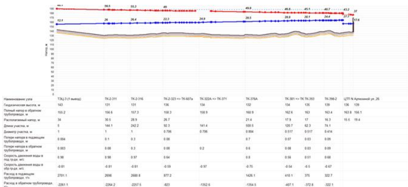
Рисунок 1.36 - Пьезометрический график вдоль пути от ТЭЦ-3 до потребителя по адресу г. Тверь, ул. Артюхиной 26
